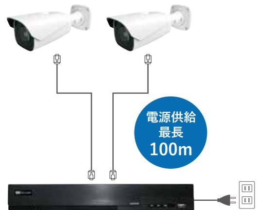
PoEポートにカメラを接続することで、カメラのIPアドレスを自動的に割振り、電源を供給することができます。
