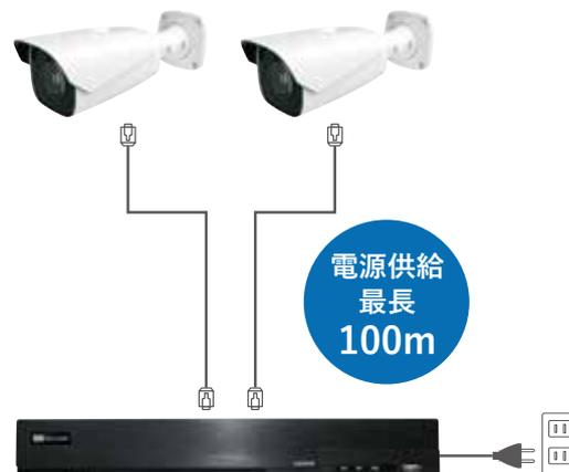
PoEポートにカメラを接続することで、カメラのIPアドレスを自動的に割り振り、電源を供給することができます。
