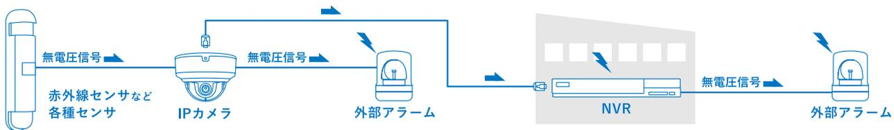
赤外線センサなどの各種センサ類からの無電圧信号をIPカメラを経由することによって、IPカメラに接続された外部アラームを作動させます。
